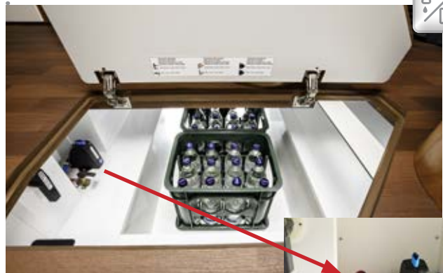
Wasserablasszentrale auch von außen durch die XL-Aufbautür bedienbar
