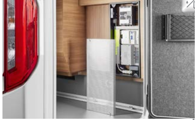
Elektrozentrale in der Rollergarage gut zugänglich
